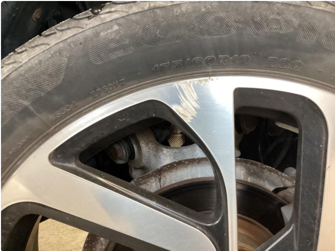
1.2 Bruksslitasje i felg
