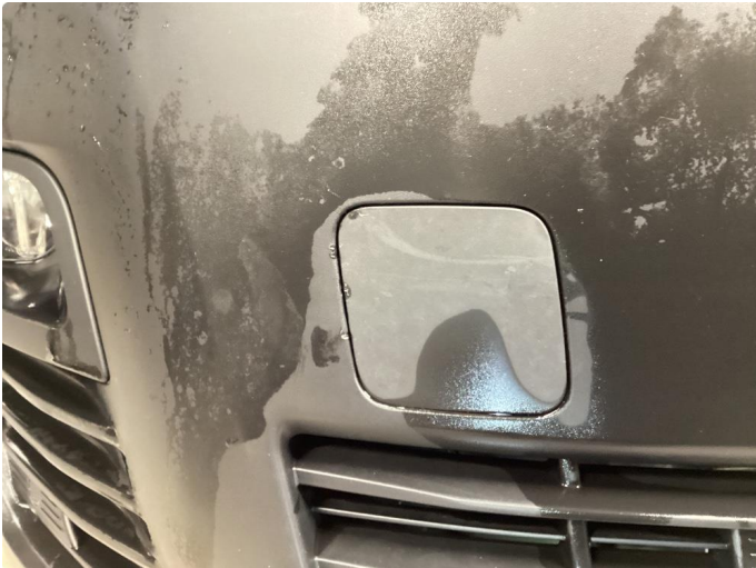
1.2 Små brytemerker rundt lokk til slepeøye etter skrujern
