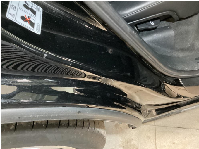
1.3 Bulk(er) med lakkskade
