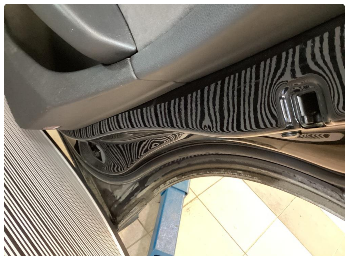
1.3 Bulk(er) med lakkskade
