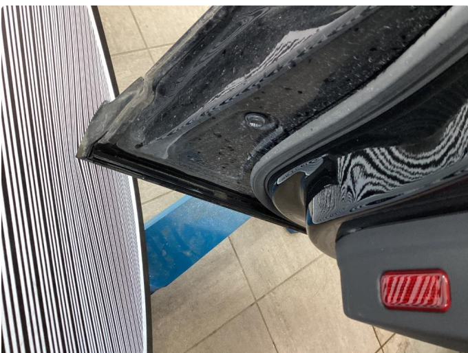
1.3 Bulk(er) med lakkskade
