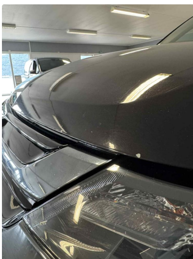
1.2 Noe steinsprut i panser
