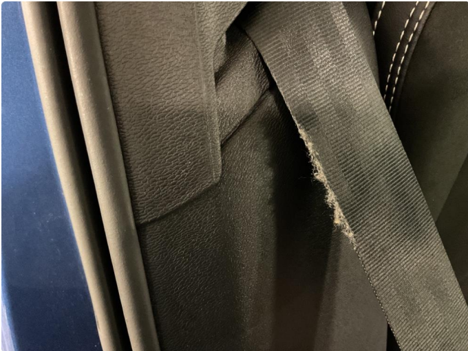
1.1 Skade på belte
