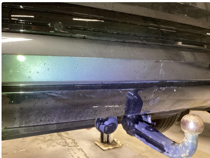
1.4 Noen riper i støtfanger bak.
