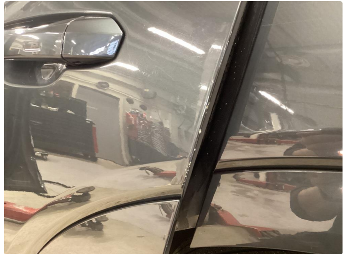
1.2 Er noen små lakkskader i kant på dør.
