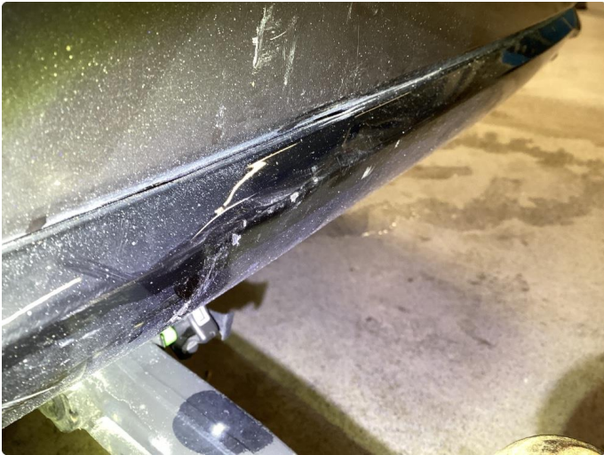
1.3 Liten bulk i diffuser etter drag på henger.
