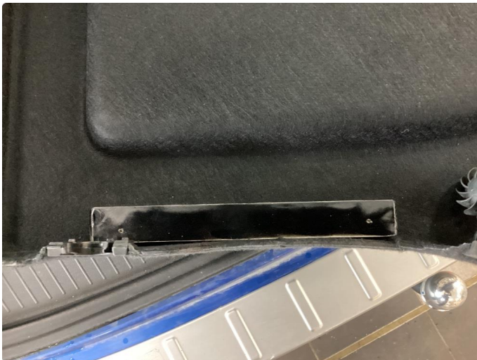
2.1 Forsterket etter skade
