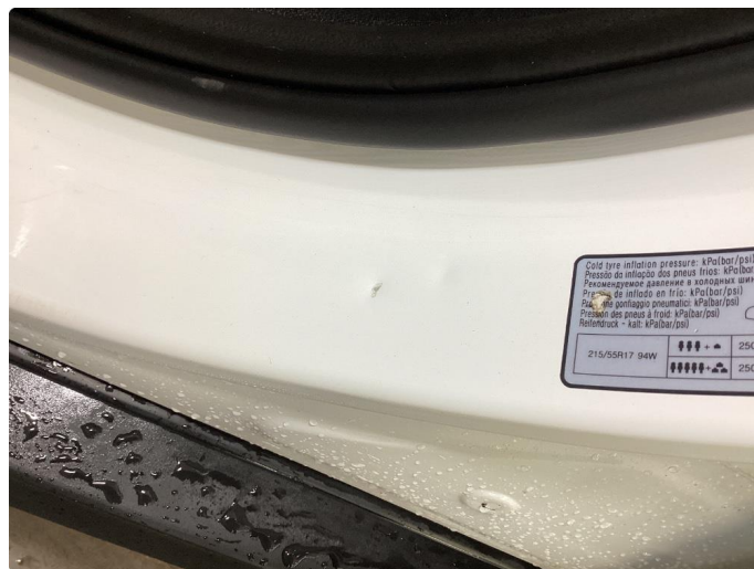
1.4 Bulk(er) med lakkskade
