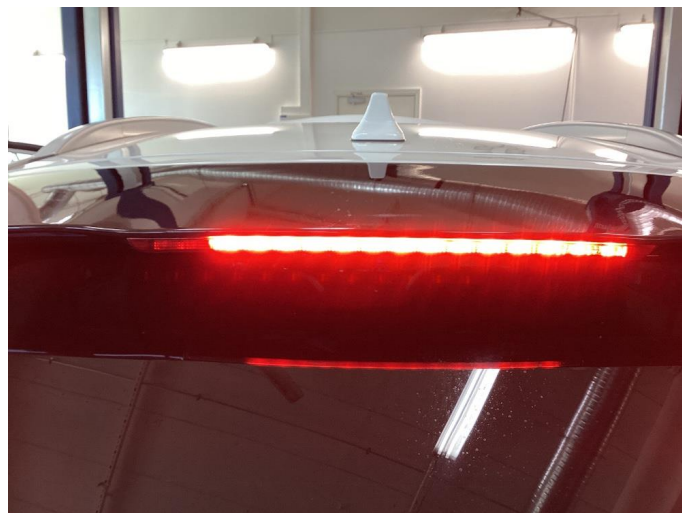
2.1 Mangler noen dioder i høyt bremselys
