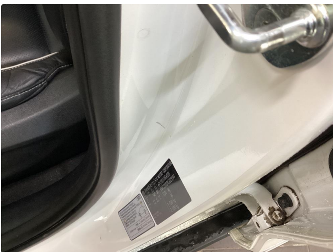
1.4 Bulk(er) med lakkskade
