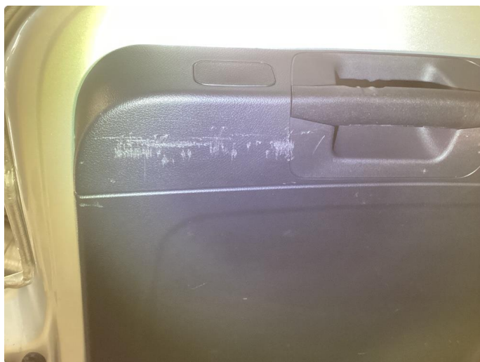
2.2 En del riper i nedre deksel i bagasjeromsluke. Er noen få merker i midtre deksel i bakluke.
