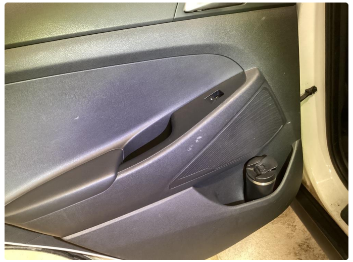
2.1 Noen merker i dørtrekk begge sider bak.
